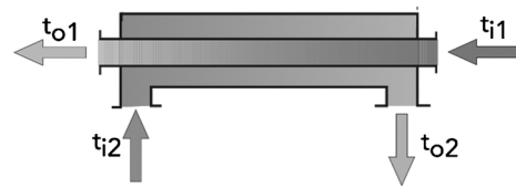
c. チューブ式伝熱模式図
